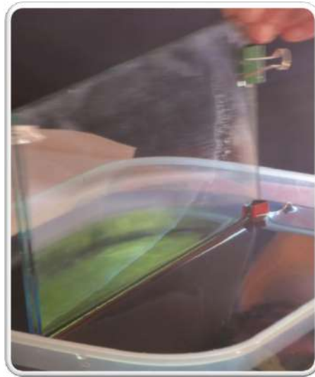
Fig. 4 La capillarità e le lastre di vetro
