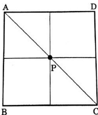
Da questo punto l'area del rettangolo diminuisce, ripassando per gli stessi valori che aveva raggiunto nella prima metà della corsa, fino ad annullarsi di nuovo, quando P coincide con C. La curva che descrive la variazione dell'area di uno di questi rettangoli è una parabola, con la concavità rivolta verso il basso.
